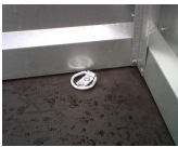
Plancher bois antidérapant avec 4 anneaux d'arrimage
